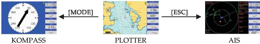
Beispiel 2: Sie sind im PLOTTER-Modus. Drücken Sie die [ESC]-Taste, erscheint der AIS-Modus im Display.
