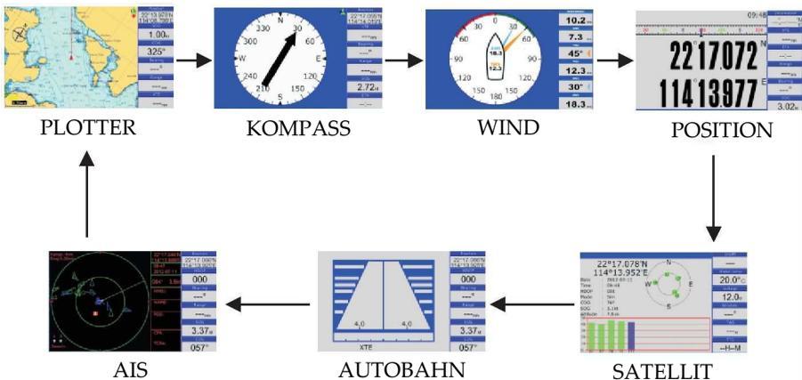
Durch Drücken der Taste **[MODE]** wählen Sie einen Display-Modus. Wird die Taste gedrückt, ändert sich der Display-Modus in der Reihenfolge, die oben zu sehen ist. Durch Drücken der Taste **[ESC]** wählen Sie einen Display-Modus in umgekehrter Richtung. Beispiel 1: Sie sind im PLOTTER-Modus. Drücken Sie **[MODE]**, erscheint der KOMPASS-Modus im Display.
