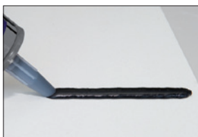
Abb. 1: Klebstoffraupe auf Originaloberfläche auftragen
