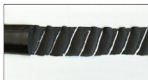
Abb. 3: Beispiel einer exzellenten Haftung
