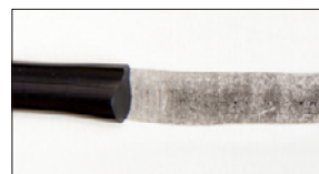
Abb. 5: Schlechte Haftung (keine Klebschicht bzw. nur Klebfilm)
