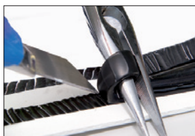
Abb. 2: Ausgehärtete Klebstoffraupe einschneiden und mit einer Spitzzange abschälen
