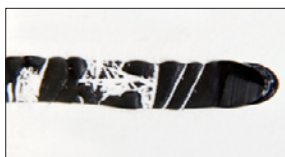
Abb. 4: Gute Haftung mit einigen Substratbrüchen auf der Oberfläche
